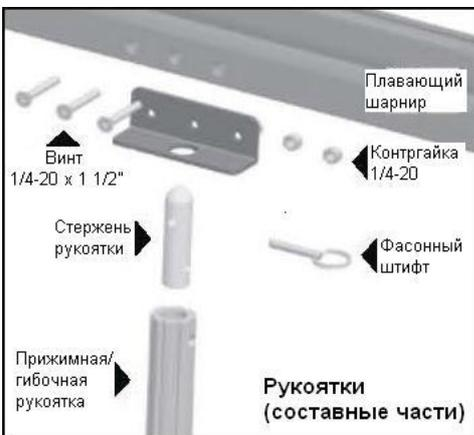
1. Вставьте один конец стержня в рукоятку и установите в отверстие фасонный штифт.
