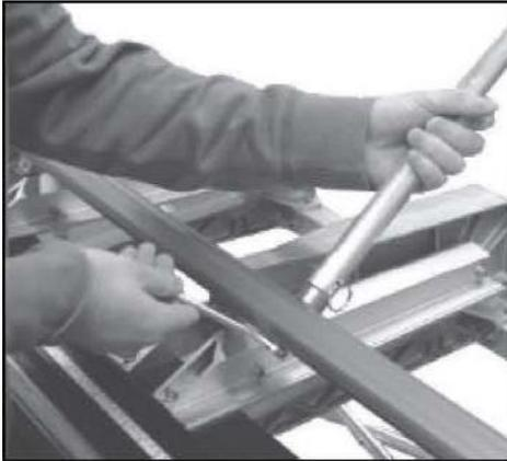
2. Расположите зажим над стержнями рукоятки и закрепите его с помощью фасонных штифтов. После этого затяните болт 3/8" с помощью ключа 9/16". Рукоятку можно снимать, просто удаляя фасонные штифты.
