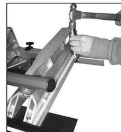
3. Закрепите линейку в месте отреза ниже края поворотного рычага. Используйте стандартный керн или пробойник.
