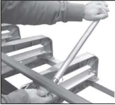
1. Вставьте болт 3/8" с шестигранной головкой в основание зажима станка (см. рисунок). **ЗАТЯГИВАЙТЕ БОЛТ ТОЛЬКО ВРУЧНУЮ.** Выполните эту операцию с обеих сторон станка.
