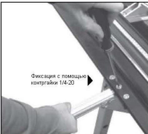
2. Теперь вставьте рукоятку в отверстие, расположенное внизу плавающего шарнира. Совместите отверстия шарнира и стержня, после чего с помощью отвертки Phillips установите в него винт (см. рисунок). Зафиксируйте винт с помощью контргайки 1/4-20.
