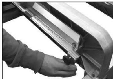
2. Сдвигайте ограничитель внутри поворотного рычага, как показано на рисунке. Рекомендуемое положение ограничителя – во втором С-образном кронштейне на каждом краю станка.
