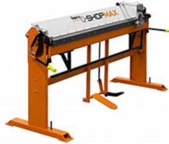
Данная серия листогибов представляет собой мощное цеховое ручное оборудование, которое используется для эффективной работы с оцинкованной сталью, имеющей толщину до 1.0 мм. Технологичная и довольно мощная конструкция с применением специальных компенсаторов прогиба балок дает возможность существенно снизить общую массу станка (от 350 кг.).
